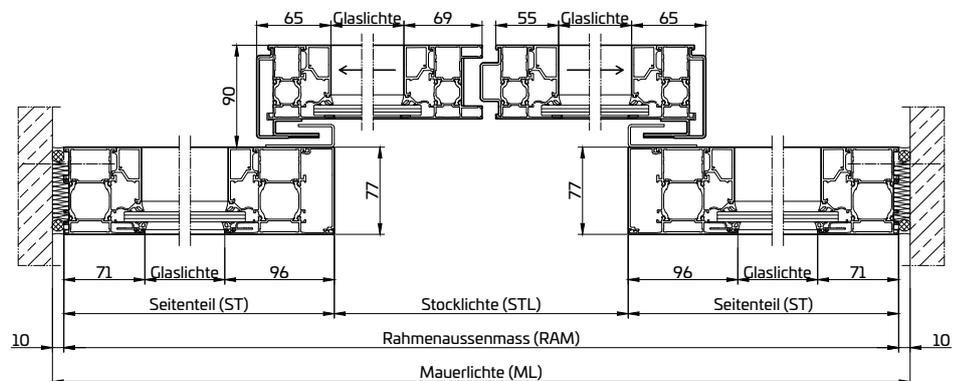
Darstellung Horizontalschnitte Flügelprofil leicht geöffnet
