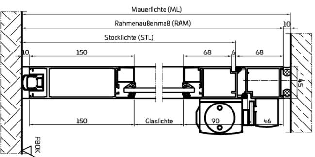
Mit Aufbautürschließer und absenkbarer Bodendichtung
