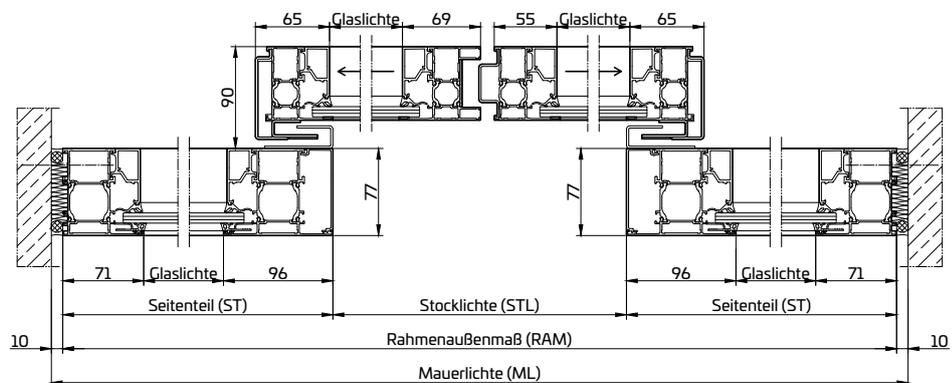
Darstellung Horizontalschnitte Flügelprofil leicht geöffnet
