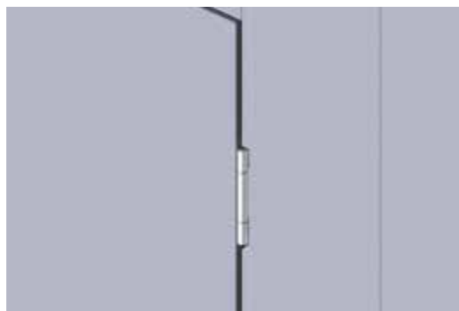
3D-verstellbare Objektbänder aus Edelstahl bei eingebauter Gehür
